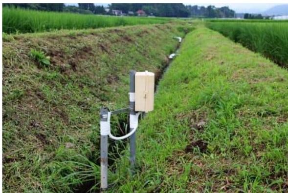
宇都宮市は新潟大学と田んぼダムの効果を検証する（写真は排水路の水位を計測するセンサーと記録装置）
